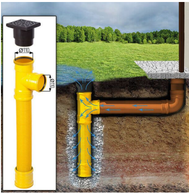
Sickerschacht mit Zufluss/Abfluss Ø 110 mm
