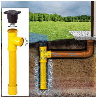
Sickerschacht mit Zufluss/Abfluss Ø 110 mm
