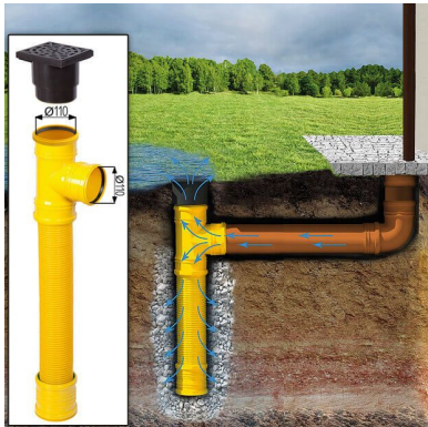
Sickerschacht mit Zufluss/Abfluss Ø 110 mm
