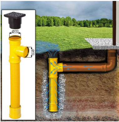
Sickerschacht mit Zufluss/Abfluss Ø 110 mm
