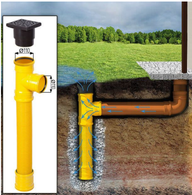
Sickerschacht mit Zufluss/Abfluss Ø 110 mm
