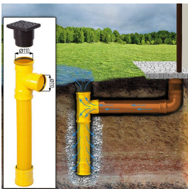
Sickerschacht mit Zufluss/Abfluss Ø 110 mm
