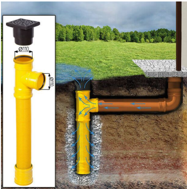
Sickerschacht mit Zufluss/Abfluss Ø 110 mm
