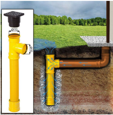
Sickerschacht mit Zufluss/Abfluss Ø 110 mm
