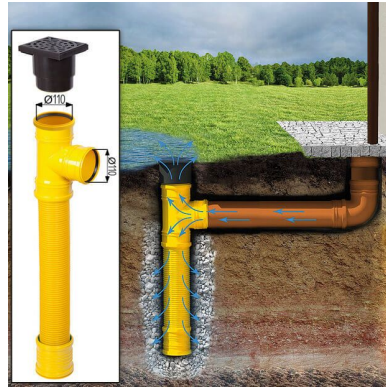
Sickerschacht mit Zufluss/Abfluss Ø 110 mm
