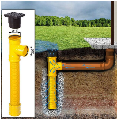
Sickerschacht mit Zufluss/Abfluss Ø 110 mm
