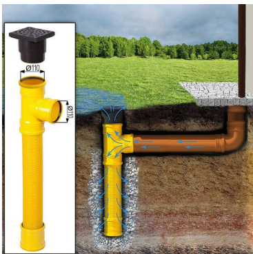
Sickerschacht mit Zufluss/Abfluss Ø 110 mm
