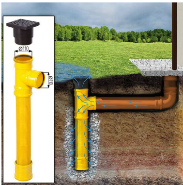
Sickerschacht mit Zufluss/Abfluss Ø 110 mm
