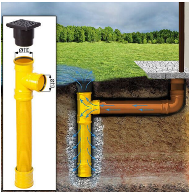
Sickerschacht mit Zufluss/Abfluss Ø 110 mm
