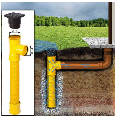
Sickerschacht mit Zufluss/Abfluss Ø 110 mm
