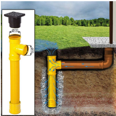
Sickerschacht mit Zufluss/Abfluss Ø 110 mm
