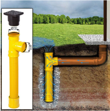
Sickerschacht mit Zufluss/Abfluss Ø 110 mm
