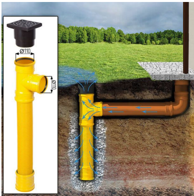
Sickerschacht mit Zufluss/Abfluss Ø 110 mm
