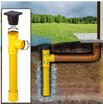
Sickerschacht mit Zufluss/Abfluss Ø 110 mm
