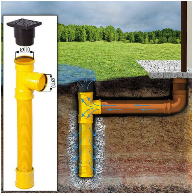
Sickerschacht mit Zufluss/Abfluss Ø 110 mm
