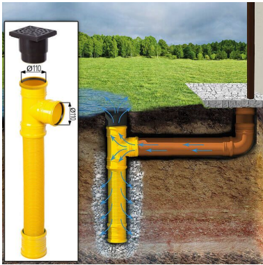
Sickerschacht mit Zufluss/Abfluss Ø 110 mm
