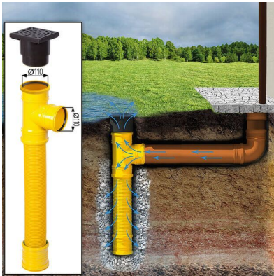
Sickerschacht mit Zufluss/Abfluss Ø 110 mm
