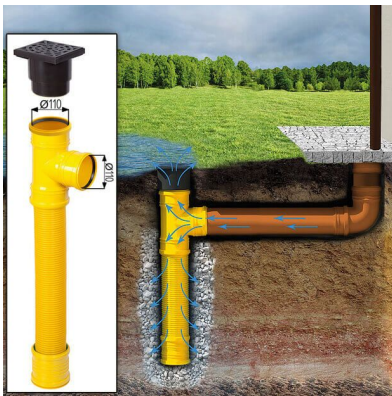
Sickerschacht mit Zufluss/Abfluss Ø 110 mm
