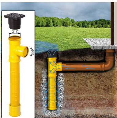
Sickerschacht mit Zufluss/Abfluss Ø 110 mm
