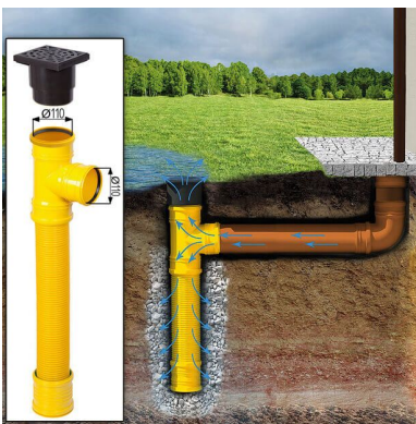
Sickerschacht mit Zufluss/Abfluss Ø 110 mm
