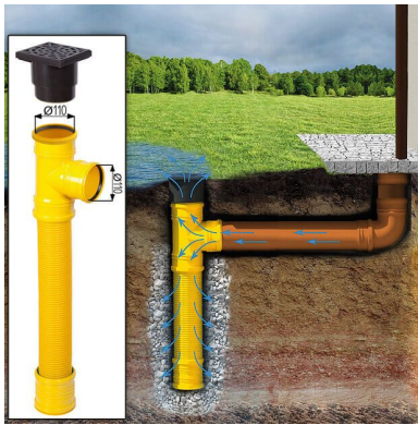
Sickerschacht mit Zufluss/Abfluss Ø 110 mm
