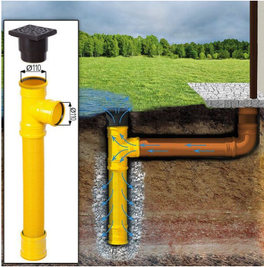
Sickerschacht mit Zufluss/Abfluss Ø 110 mm
